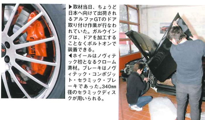
►取材当日、ちょうど日本へ向けて出荷されるアルファGTのドア取り付け作業が行なわれていた。ガルウイングは、ドアを加工することなくボルトオンで装着できる。
