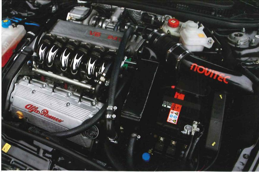
↑V6の右手には、新たに追加された遠心式のコンプレッサーが装着されている。ノーマルの240ps/29.4kgmを遙かに上回る337ps/39.6kgmを発揮。低域でむずがることもなく、チューンドとはいえ、扱い易い
