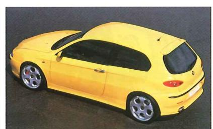
フロント、リヤ、ルーフの各スポイラー、そしてサイドバネルセットといったバースによって精悍な佇まいをみせるノヴィテックの147。ホイールはNOVITEC type N5 8JX18inchでタイヤはミシュランもしくはピレリの225/40R18を履かれる。
