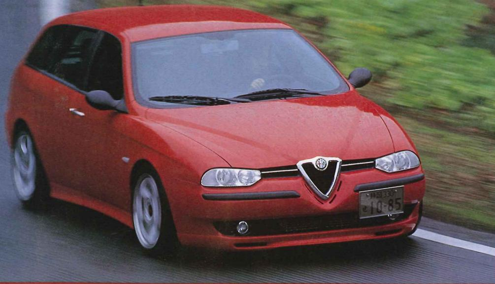
もノヴィテックによってターボチャージヤがビルトインされている1台。ノヴィテック・ジャパンによりコンプリートカーとして販売されるモデルだ。高出力に合わせた吸排気系の容量増大とタービンの抵抗によって、2500rpmより下では少々頼りない。もっともノーマルのエンジンとてトルク感が大きい方ではないから、ピクアップが鈍くなってしまうたのさえ我慢すれば、3000rpmから上は溢れるようなトルクによる豪快な走りが楽しめる。パワーバンドでのフィーリングは、回転フィール、トルク感とも絶品で、5速MTのシフトワークでどの速度域でもパワフルな走りも味わえるのだ。
