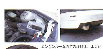
写真中央が例のインテーク部。確かに、ヘッドライトハイビームが取り外されている。室内に張り巡らされたロールケージは同店オリジナル。シフトノブ＆シャフトもオリジナル商品だ。BMW M POWERという文字が隠れていながら、話題のノロジーホットワイヤーを組み込んでいる。圧縮・引っ張りに対していかにも強度がありそうなストラットタワーバーもオリジナル。ヘッド上部を壊すのを嫌って、エンジン後部を通しているところがアイデアか。高性能なバーツ群は高性能なクルマにはマスト、という訳でこのBMW、予選ではポールポジションを獲得した。
