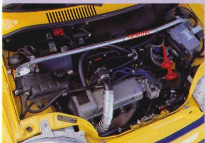
ストラットタワーバー、ハイテンションコード、ダイレクト・エアクリーナー、耐熱テープで武装したエンジルーム。でもやはり、スペックほどの過激さは伝わってこない。(上) 今回の試乗車のエアロバーツはセイチエント・スポルティング・アバルトに装着されている純正品であるが、ノヴィテックでもフロント&リアのエアロバンパー、アイマスク、可変ウイング付きのリアウイングなどが用意されている。(右)
