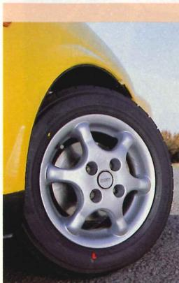
過去にWRCに出場したグループA車両にも装着されているマグネシウムホイール。ブレーキはブリントGT製。
